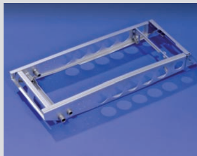
MAG-Schweißen | PKW-Mittelarmlehne 500 x 200 x 70 mm
